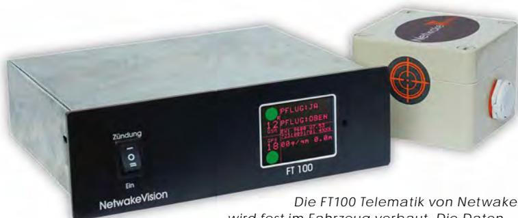
Die FT100 Telematik von Netwake wird fest im Fahrzeug verbaut. Die Datenerfassung von beliebigen Anbaugeräten erfolgt kabellos durch den Einsatz der W-Box. Es können dabei mehrere W-Boxen gleichzeitig verbunden werden.
