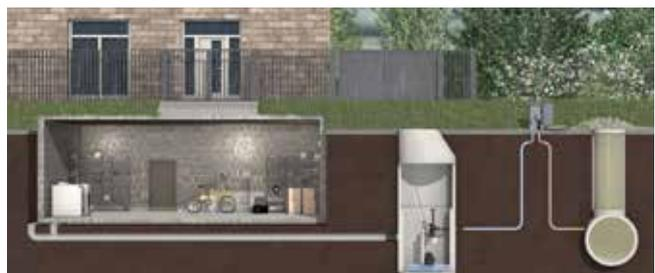
Hier die Grundkonfiguration für sicheren Rückstauschutz: via Hebeanlage plus Rückstauschleife zum Kanal. Bild: Mall GmbH
